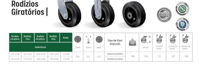
GSC 62 BR - Borracha Moldada. Dureza: 80 Shore A. (-20°C e +70°C) - Produzidas com revestimento de borracha moldada vulcanizada em núcleo de ferro fundido cinzento. Rodam com suavidade e baixo nível de ruídos, absorvem choques e vibrações.
