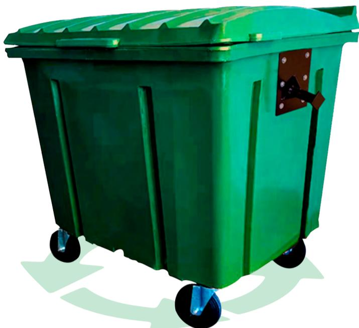
Contentor 1000 Litros para Coleta de Resíduos, Volume Nominal de 1000 Litros, fabricado em conformidade com a Norma ABNT NBR 15911-3, composto de Corpo, Tampa, Rodízios, Dreno, MUNHÃO DE AÇO com limitador de Segurança para Basculamento Lateral e REFORÇO DE AÇO nos Rodízios.
